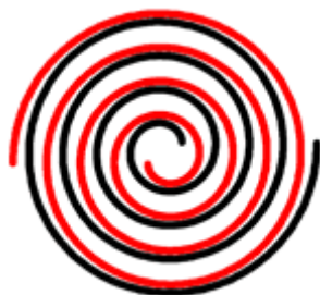
Рис. 3. Принципиальная схем спирального компрессора.
